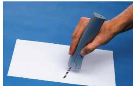
Der speed-i-Jet 798 wird über die zu bedruckende Oberfläche gezogen
