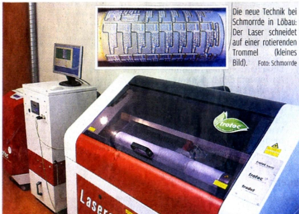
Die neue Technik bei Schmorrdede in Löbau: Der Laser schneidet auf einer rotierenden Trommel (kleines Bild). Foto: Schmorrdede
